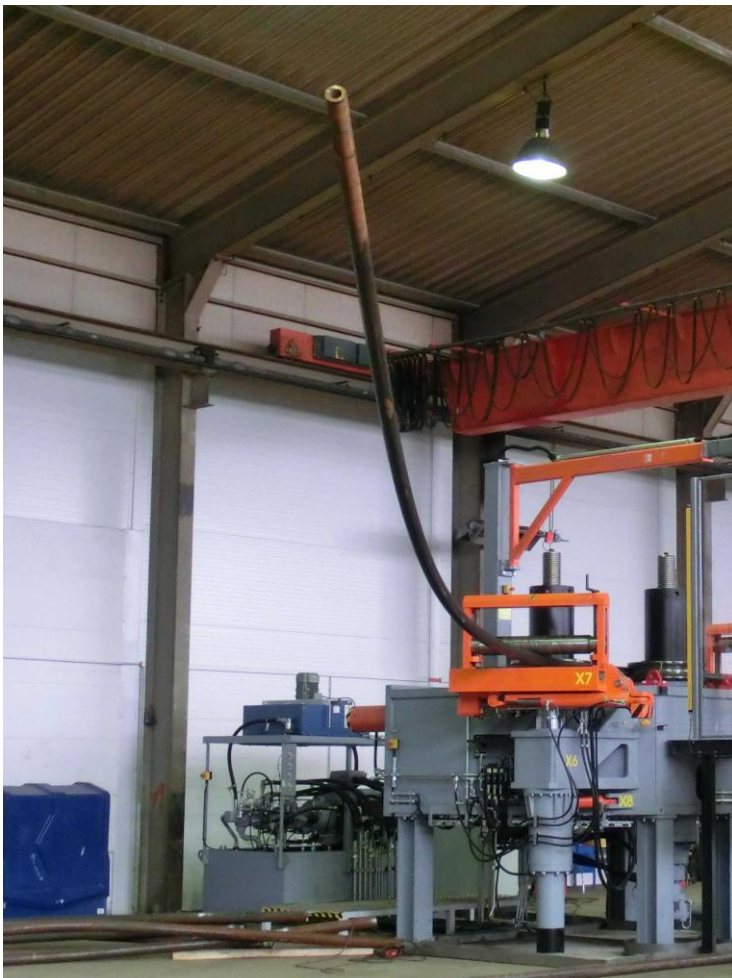
Bild 3: XBEND-Biegemaschine im Einsatz
