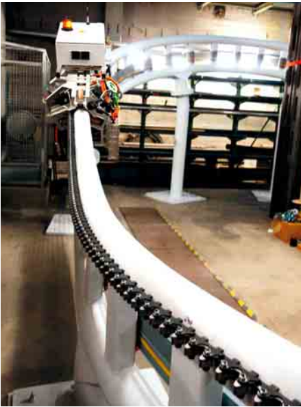
Teilabschnitt des im IFT aufgebauten 50 m langen Test-Ovals.
