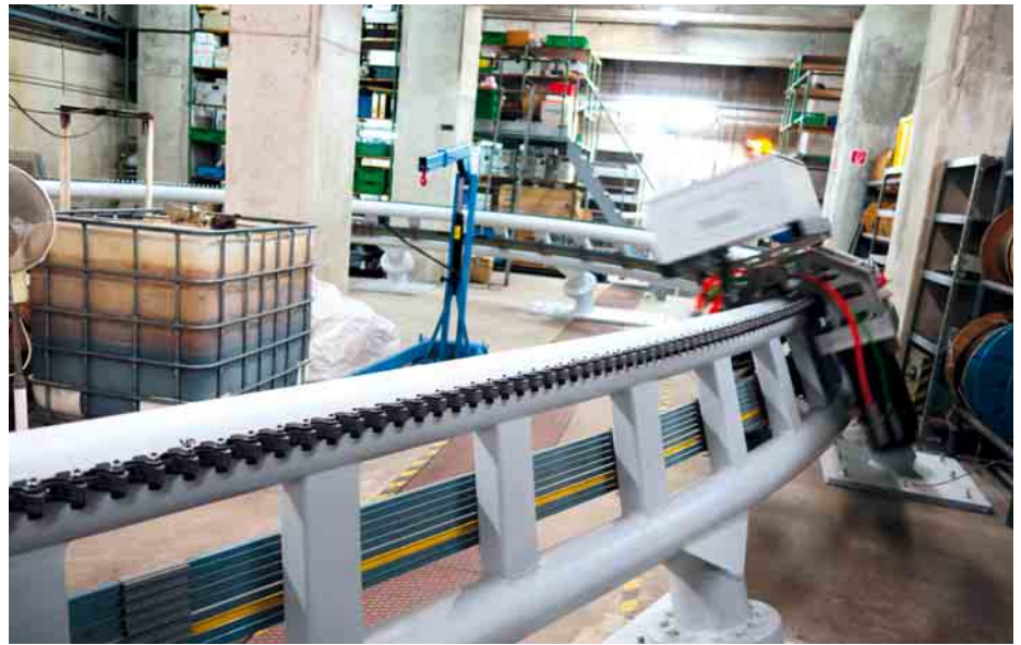
Das auf der Schiene geführte Fahrzeug kann eine Geschwindigkeit von 17 m/s erzielen.
